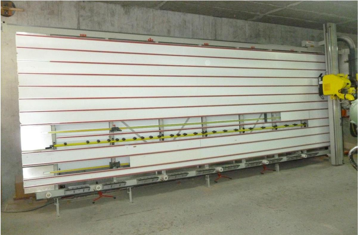
Diese Strebig kann sehr grosse Platten millimetergenau fräsen
