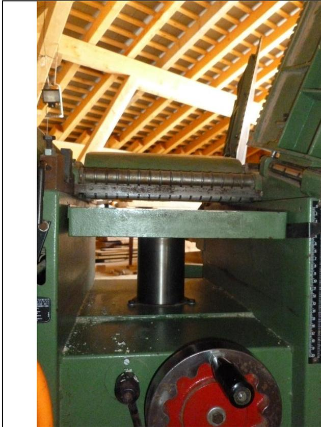
Da nicht alle Holzteile gleich breit waren, habe ich die zu breiten Hölzer zweimal über die Hobelmaschine gestossen. Die Hobelmaschine ist auf der gleichen Maschine wie die Fräse.
