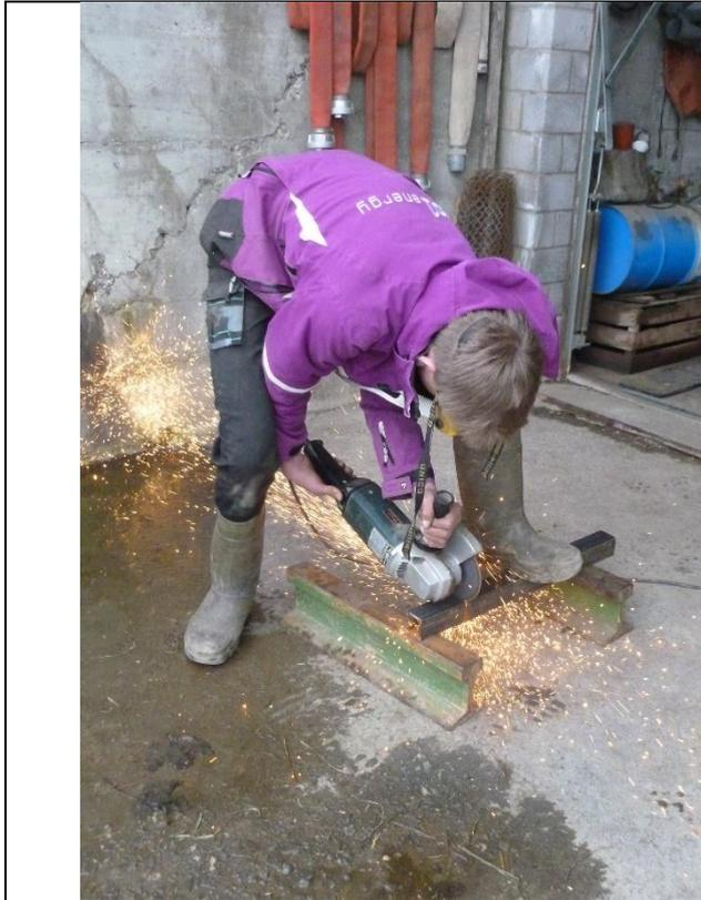
Als Verbindungshalter dienen U- Eisen. Sie halten die vier Teile des Fuss-Billards zusammen. Mit dem Winkelschleifer habe ich die U-Eisen abgetrennt.
