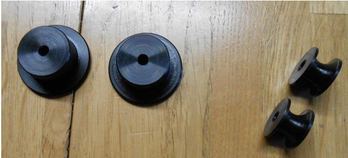
Abbildung 9 Links die Fahrzeugrollen, rechts die Seilrollen (Feuz, Bilder Stoos , 2016/2017)
