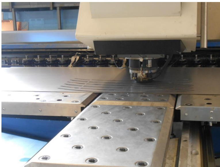
Abbildung 10 CNC Maschine beim Stanzen der Gleise (Feuz, Bilder Stoos , 2016/2017)
