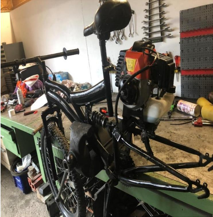
Nachdem die Farbe getrocknet war, montierte ich den Motor an die Halterung an.
