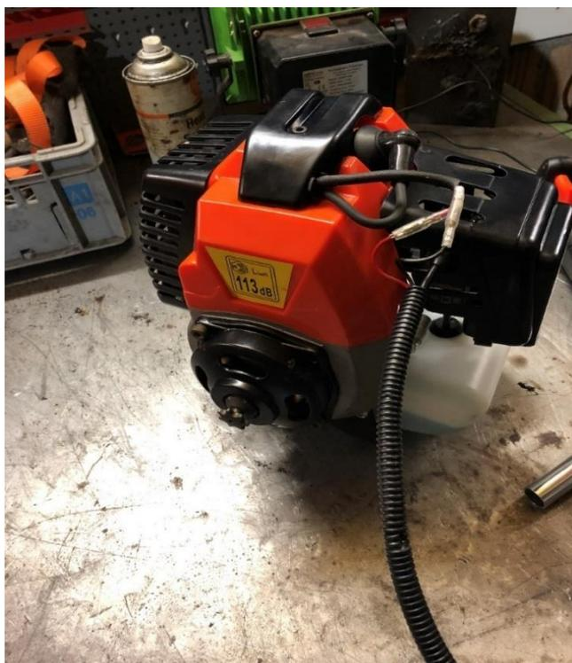
Hier habe ich die Fliehkraftkupplung am Motor montiert.
