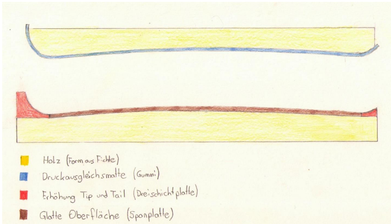
Abbildung 23 Plan von Pressform, (Zahler, 2019)
