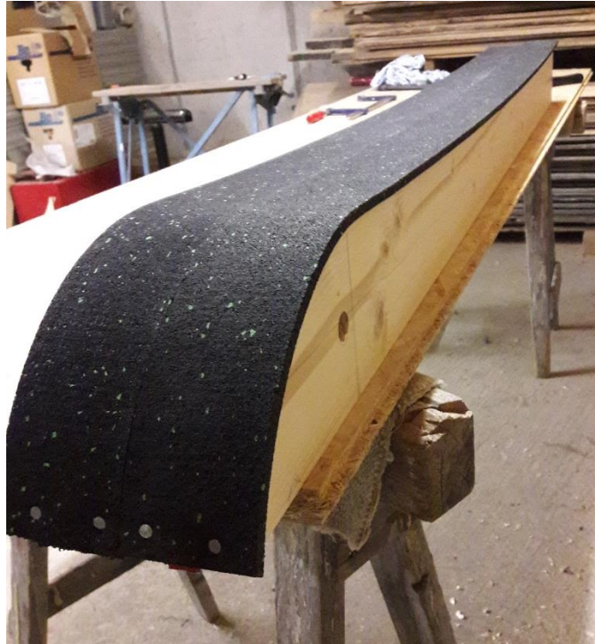
Abbildung 25 Obere Pressform, (Zahler, 2019)
