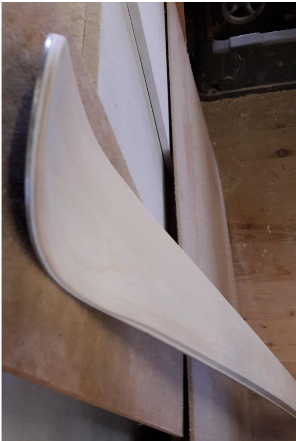
Abbildung 36 Durchläufige Kante beim Spitz, (Zahler, 2019)
