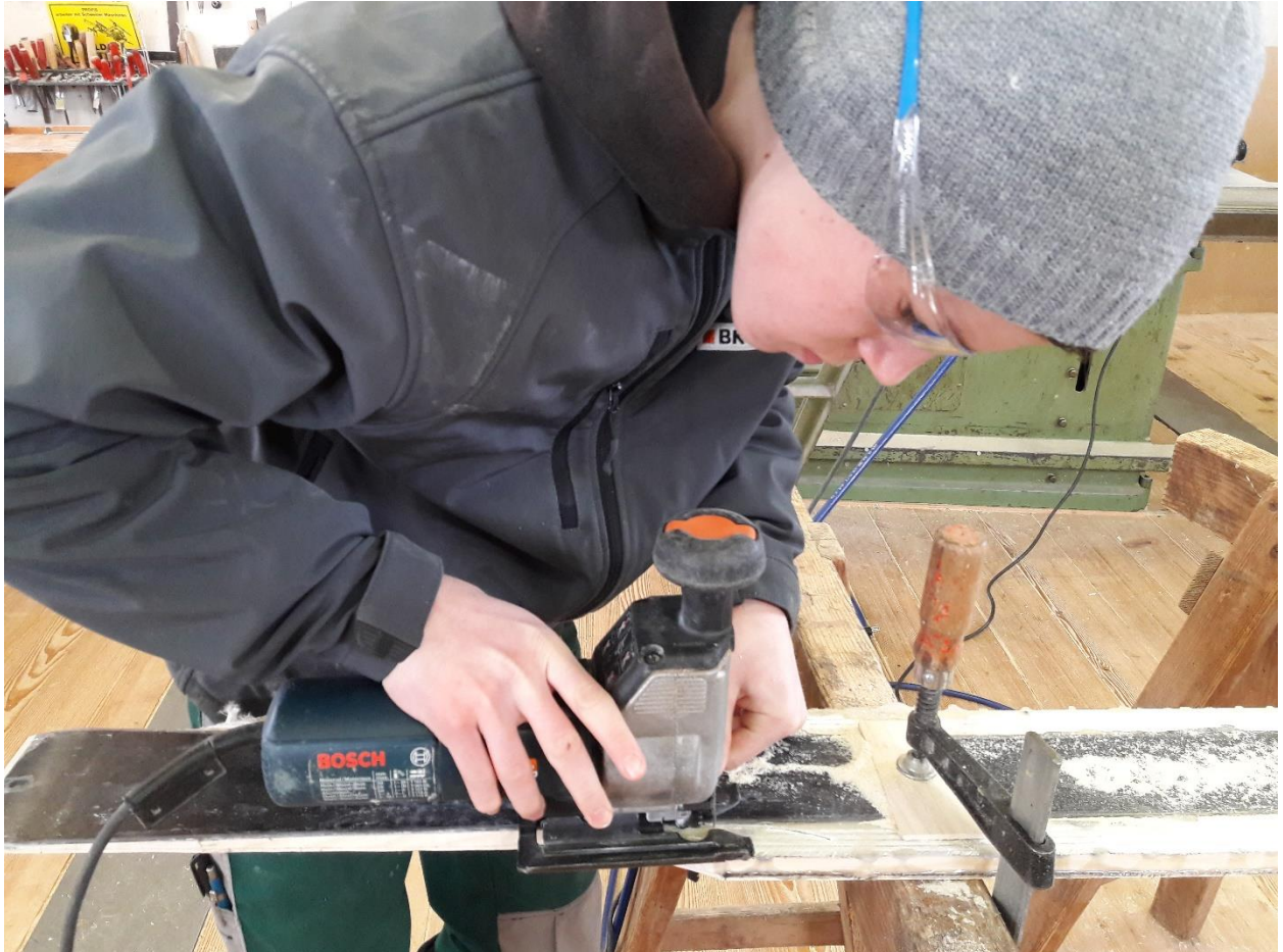
Abbildung 35 Exakt ausschneiden mit Stichsäge, (Zahler, 2019)
