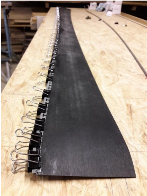
Abbildung 28 Kante an Belag geklammert (Zahler, 2019)
