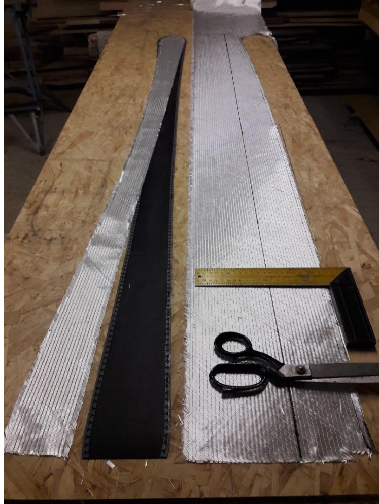
Abbildung 31 Glasfaser zuschneiden, (Zahler, 2019)
