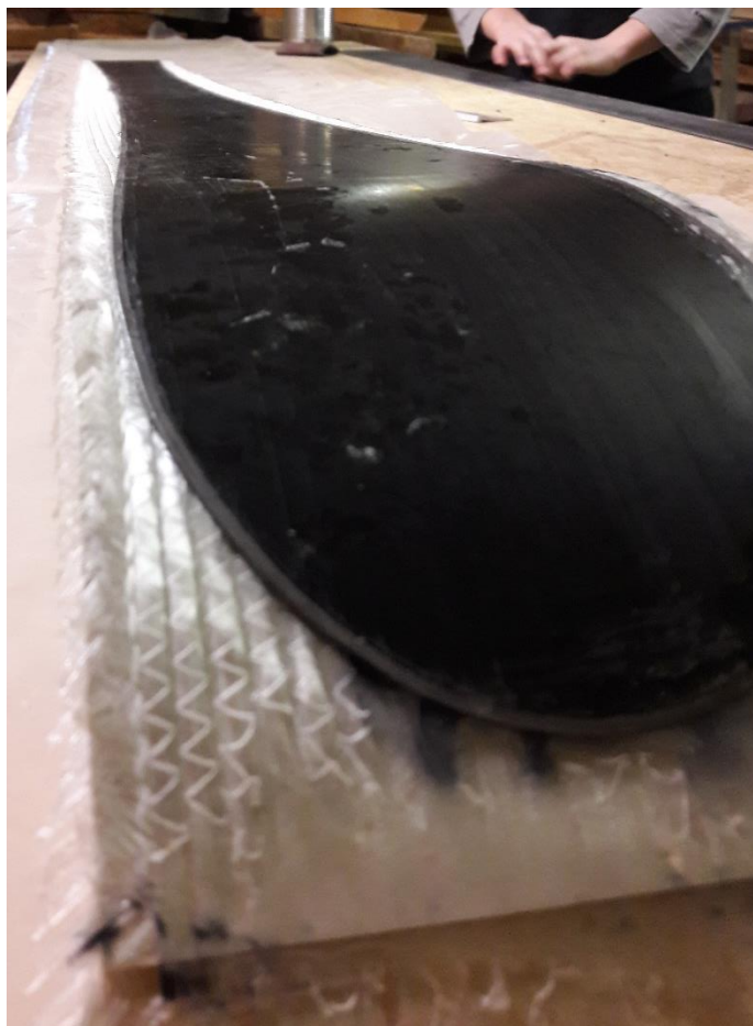
Abbildung 34 Frisch aus der Presse (Unterseite), (Zahler, 2019)
