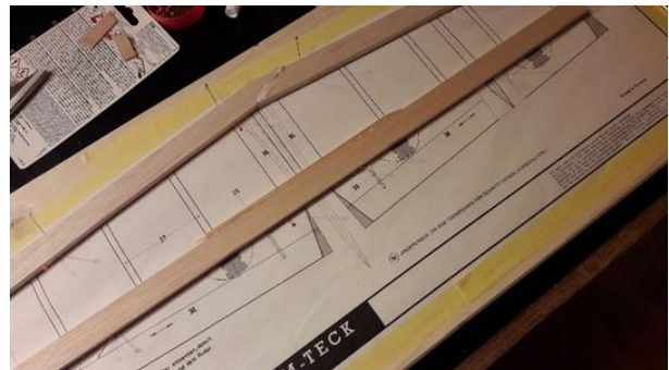
Abbildung 28 Bauen des Leitwerks
