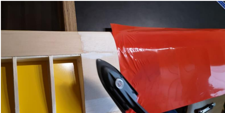
Abbildung 32 Bespannung der Tragfläche
