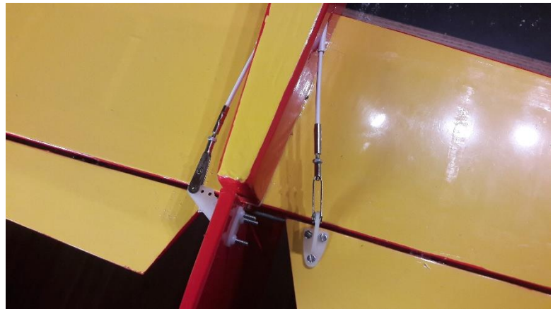
Abbildung 37 Bowdenzug an Rudern anbringen
