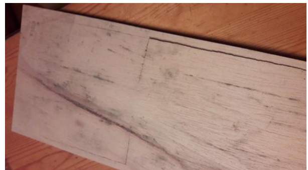
Abbildung 20 Schimmel auf Nebenrumpfteile
