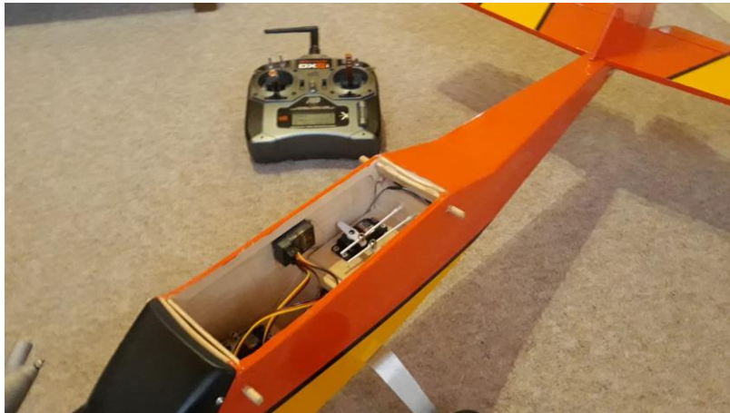
Abbildung 41 Koppung der Fernbedienung
