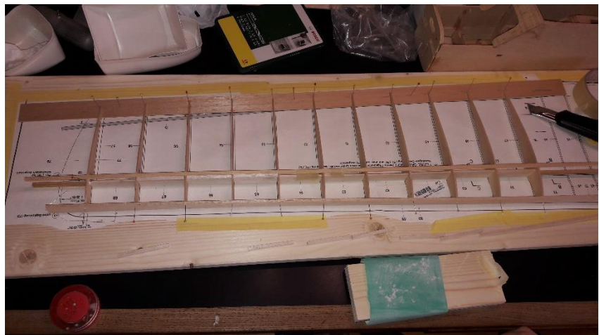
Abbildung 30 Bau der rechten Tragfläche
