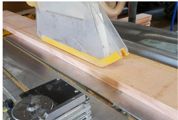
Abbildung 20 Bretter korrigieren auf der Kreissäge
