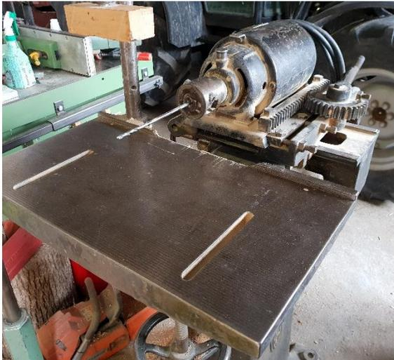
Mit der Langlochbohrmaschine habe ich die Löcher quer durch die Eckpfosten gebohrt.
