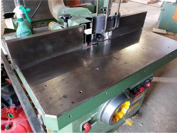
Mit der Kehlmaschine habe ich die Nuten bei den Eckpfosten und bei den Brettern rausgefräst.
