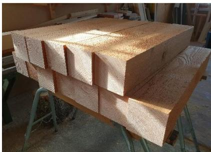
Abbildung 10 Abgelängte Eckpfosten
