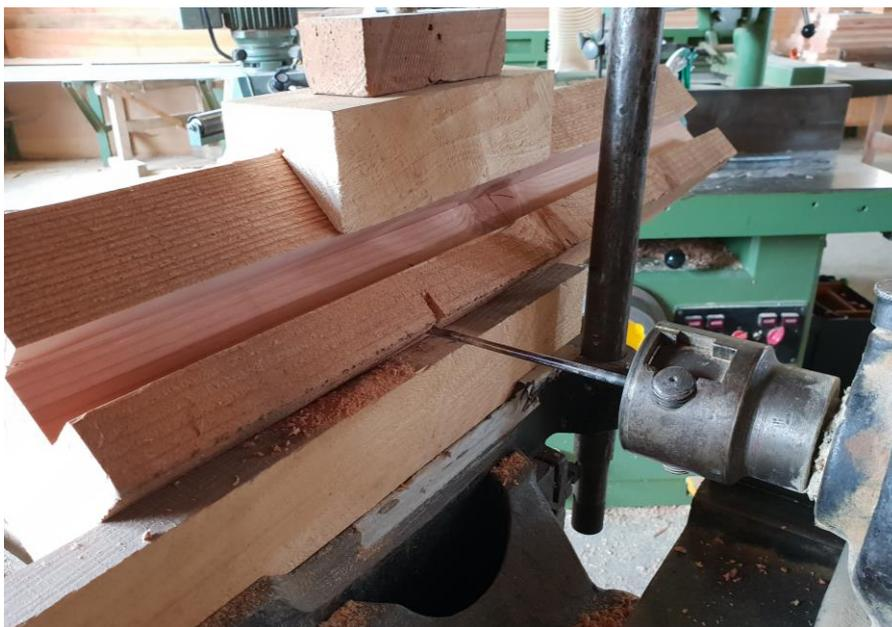
Abbildung 22 Löcher durch die Eckpfosten bohren
