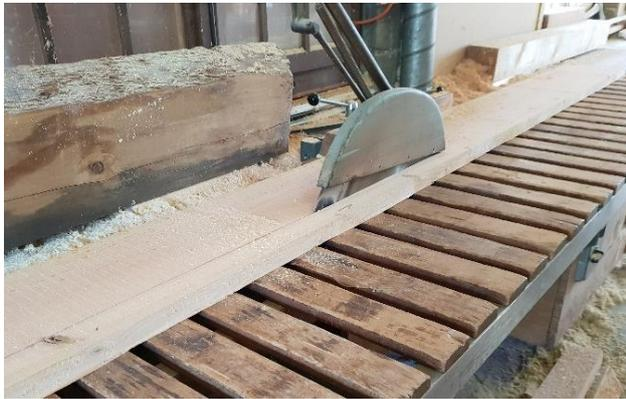
Abbildung 12 Bretter sägen auf der grossen Kreissäge
