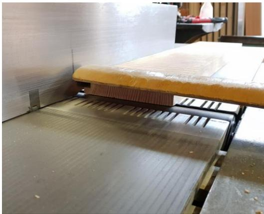
Abbildung 19 Bretter korrigieren auf der Hobelmaschine
