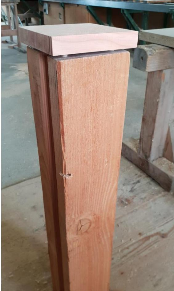
*Abbildung 27 Eckpfosten mit Deckel*
