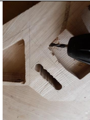
Abbildung 30 Kanallöcher bohren (Silvano, 2019)
