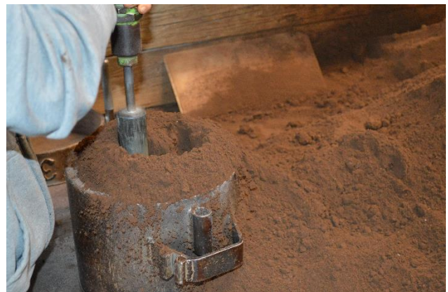
Abbildung 2 (Bringold, 2019) Befestigen des Sandes
