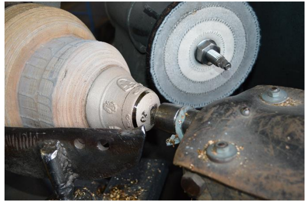
Abbildung 7 (Bringold, 2019) An diesem Drehbank werden die Glocken abgedreht.
