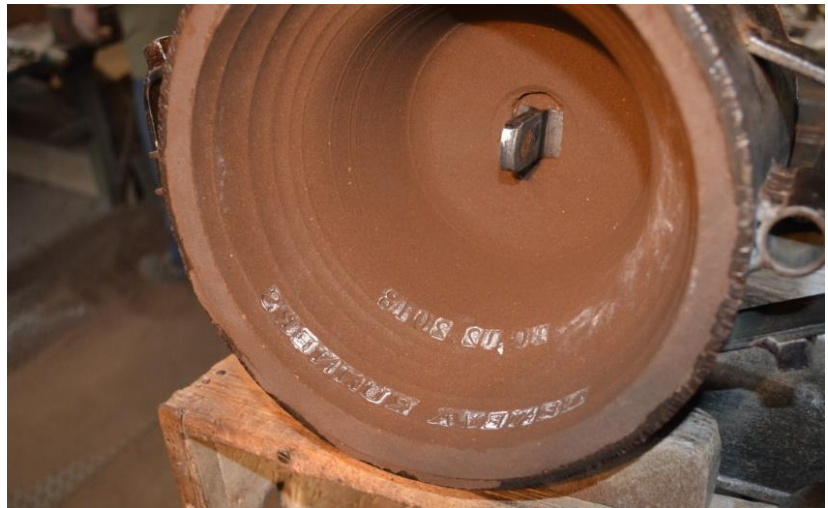
Abbildung 3 (Bringold, 2019) Die Buchstaben werden in den Sand gedrückt.
