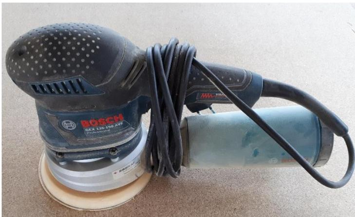
Abbildung 53 Kreisschleifer (Zimmermann, Eigene Bilder, 2019)
