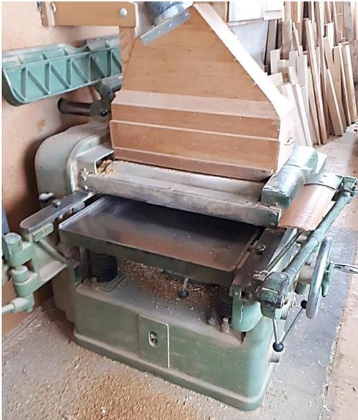
Abbildung 27 Hobelmaschine (Zimmermann, Eigene Bilder, 2019)
