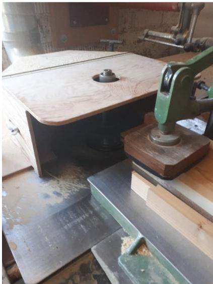
Abbildung 35 Schlitzen, zapfen
