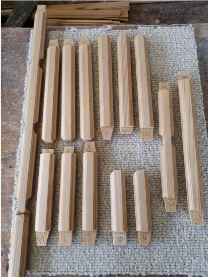
Um das Profil der Sprossen zu machen, konnten wir die Sprossen durch die Kehlmaschine stossen.
