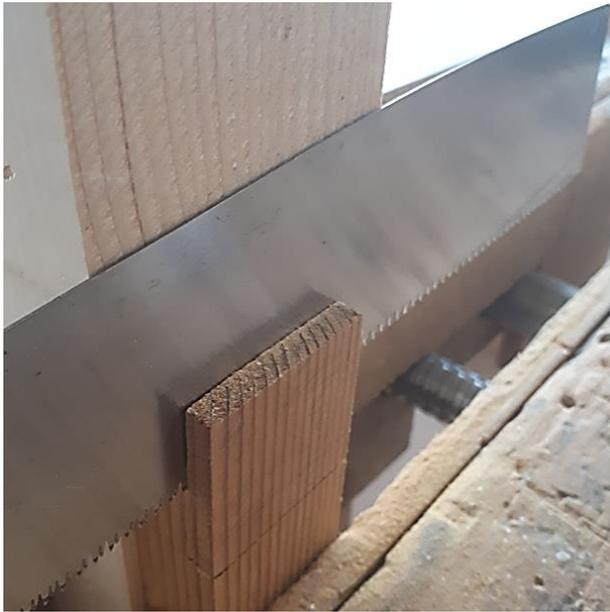
Abbildung 13 Zapfen, schlitze sägen (Zimmermann, Eigene Bilder, 2019)
