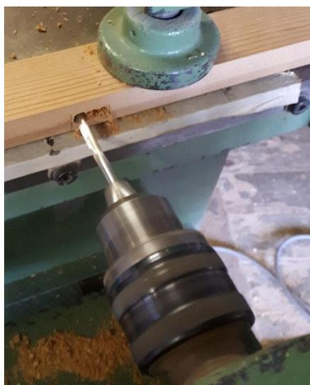
*Abbildung 39 Kleine Löcher herausbohren (Zimmermann, Eigene Bilder, 2019)*
