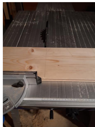
Abbildung 13 Zuschneiden einer Frontseite.
