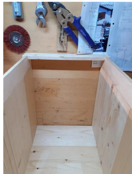
Abbildung 16 Die Leiste ist zur Stabilisation da.
