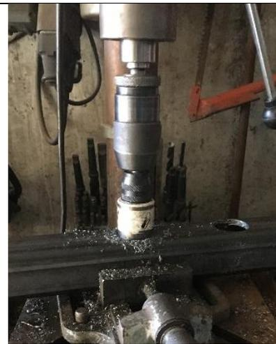
Abbildung 8 Bohren Mit Dosenbohrer (Rieder, 2019)
