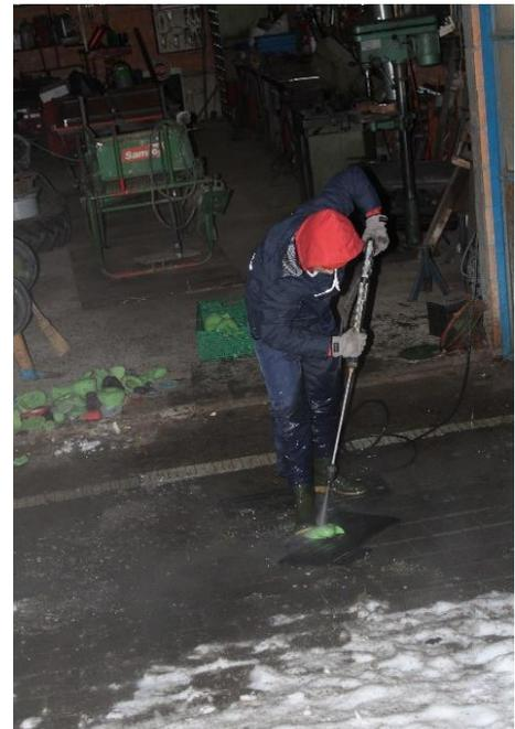
Abbildung 19 Das Griffewaschen mit dem Hochdruckreiniger.
