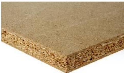
Abbildung 18 Spanplatten (www.wecobis.de, 2020)
