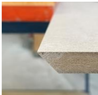
Abbildung 17 Hier sieht man, dass wir die Ecken der Einlagen abgechrägt haben. (Bowie, 2021)
