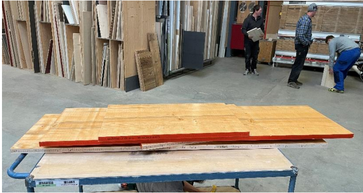
Abbildung 12 Hier sieht man die zugeschnittenen Schalungstafeln. (Bowie, 2021)
