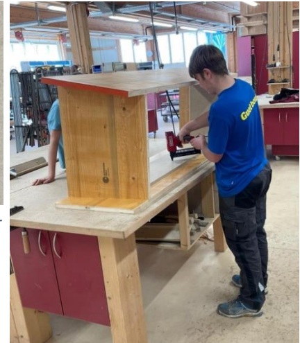
Abbildung 18 Auf diesem Bild sieht man mich, wie ich die Einlagen an der Aussenschalung mit der Nagelpistole annagle. (Bowie, 2021)
