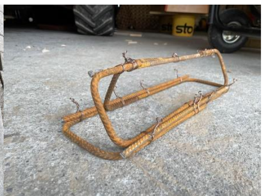
Abbildung 23 Auf diesem Bild sieht man die Armierung der Betonsockel. (Bowie, 2021)
