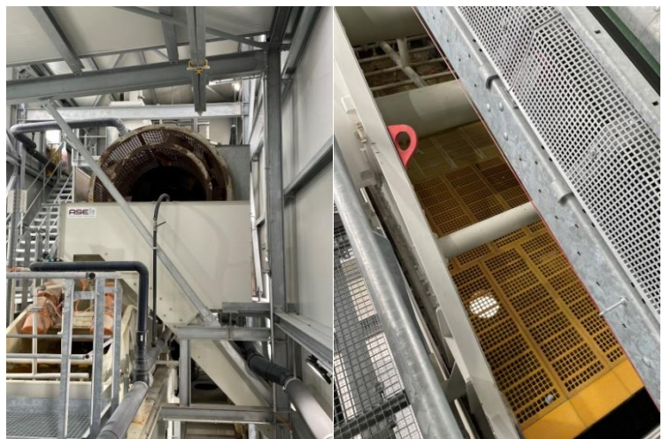
Abbildung 38 Hier sieht man das Sieb, mit dem die grossen Steine von den kleinen getrennt werden. (Bowe, 2021).
