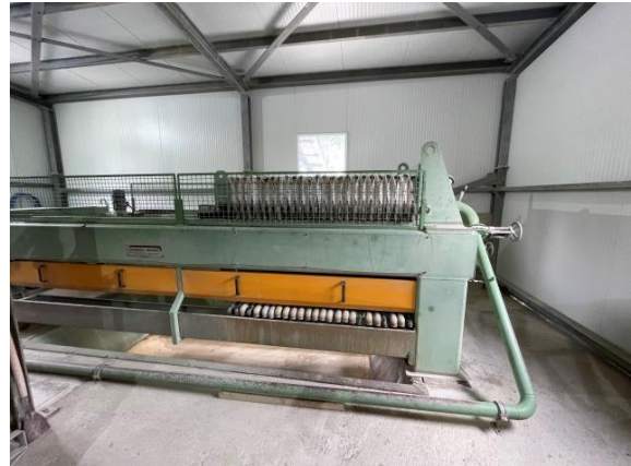
Abbildung 39 Hier sieht man die Schlammpresse, die den Schlamm zu festen Platten presst. (Bowe, 2021)
