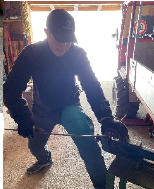
Abbildung 11 Hier sieht man mich beim Biegen der Armierungseisen. (Bowie, 2021)
