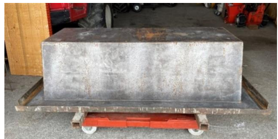
Abbildung 6 Auf dem Bild sieht man die Innenschalung aus Eisen. (Bowie, 2021)
