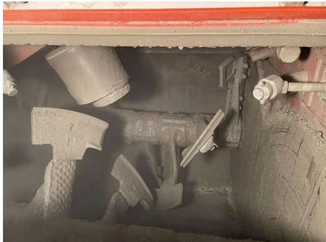
Abbildung 40 Hier sieht man den Mixer, in dem alle Zutaten für den Beton zusammengemixt werden. (Bowe, 2021)
