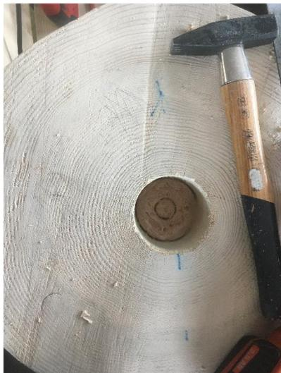
Abbildung 16 Durstlöcher Bohren (Feuz, 2020)
