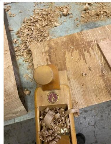
Abbildung 5 Da habe ich die Oberfläche des Musterstücks mit einem Handhobel gehobelt
