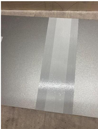
Abbildung 10 Dort wo sich das Harz befinden wird, haben wir mit Spezialklebeband abgeklebt
