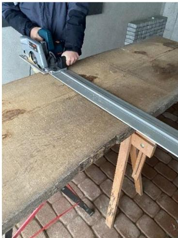
Abbildung 6 Man sieht, wie ich die Holzplatte zuerst mit einer Handkreissäge auseinandergesägt habe
