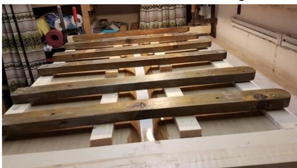
Abbildung 21 Die Form ist so weit fertig und bereit zum Giessen
