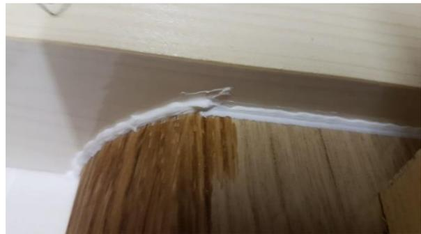
Abbildung 20 Hier habe ich die Kanten der Tischplatte in der Form abgedichtet
