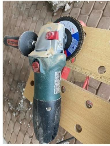
Abbildung 4 auf dem Bild ist ein Winkelschleifer abgebildet mit einer Fächerscheibe darauf
