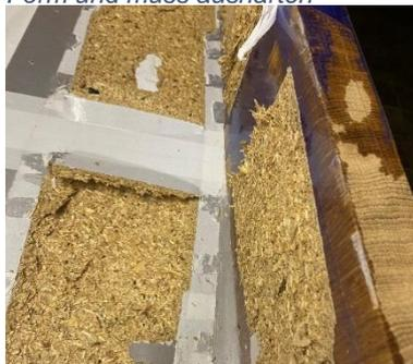
Abbildung 12 Auf dem Bild sieht man sehr gut, wie die ganze Spanplatte am Musterstück klebte
