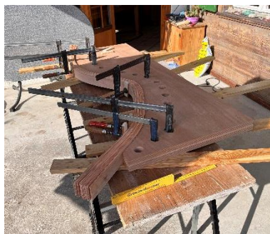
Abbildung 24 Nasses Holz in der Form
