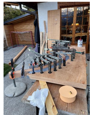
Abbildung 25 Geleimtes Holz in der Form
