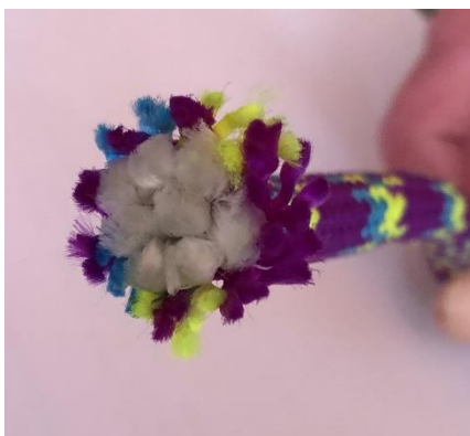
Abbildung 11 Aufgeschnittenes Seil (innen: Seilkern, aussen: Seilmantel) (Rieder Kim, 2022)
