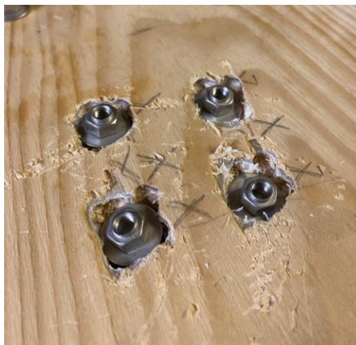
Abbildung 35 Gebohrte Löcher für die Inserts
