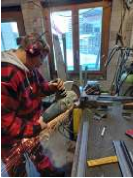
Abbildung 13 Mit der Trennscheibe die 45° Winkel am schneiden (Loris, 2022)
