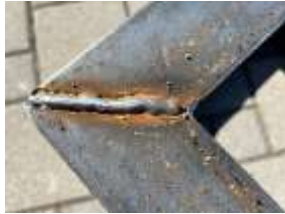
Abbildung 17 Schweißnaht nicht geschliffen (Loris, 2022)
