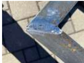
Abbildung 18 Schweißnaht geschliffen (Loris, 2022)
