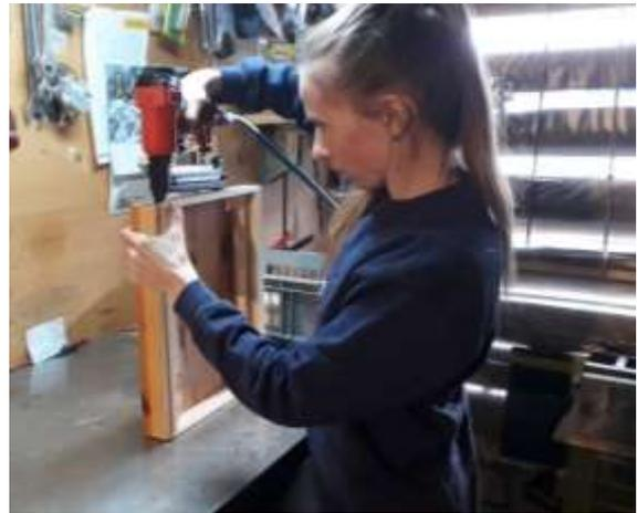
Abbildung 23 Rähmchen zusammensetzen mit der Nagelpistole
