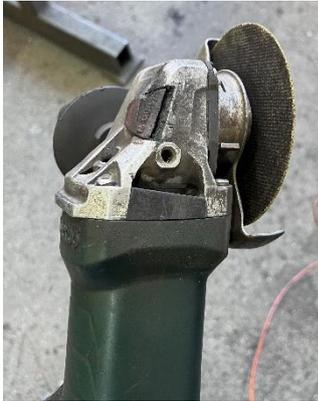
Abbildung 43 Winkelschleifer mit Trennscheibe, Elena Schumann, 23. Februar 2022
