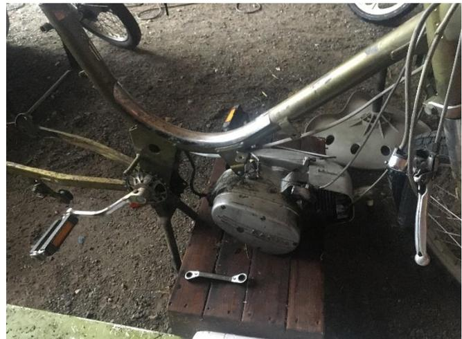
Dann musste man den Motor wegnehmen und dann den Rahmen schleifen. Den Rahmen muss man mit einer Poliermaschine wegnehmen, aber man muss zuerst noch mit einem anderen Aufsatz den alten Lack wegnemen. An die Stellen, wo man nicht dazukommt, muss man von Hand wegschleifen. Diese Teile, die man für den Zusammenbau braucht, können bei Mofa Kult
