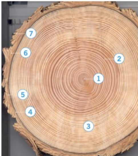
Abbildung 39: Baumaufbau, (ZFA Lehrmittel, 2023)
