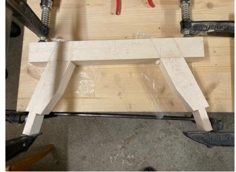
Abbildung 20 / Verleimen des Joches (Zahler, Bild)
