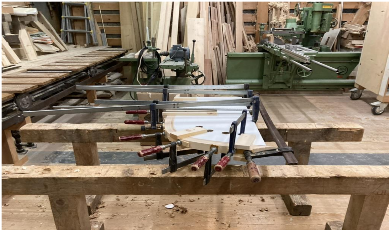
Abbildung 15 / Geleimte Lamellen befestigt (Zahler, Bild)
