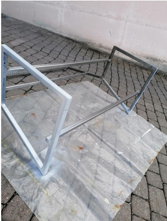
Abbildung 20 Auf diesem Bild kann man gut erkennen als ich das Gestell mit dem Primer grundiert habe
