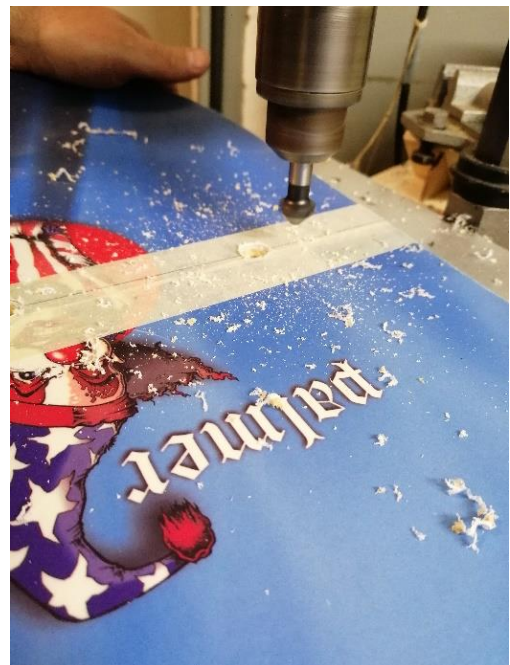
Abbildung 17 Hier kann man sehen, wie ich die Löcher zur Halterung gebohrt habe
