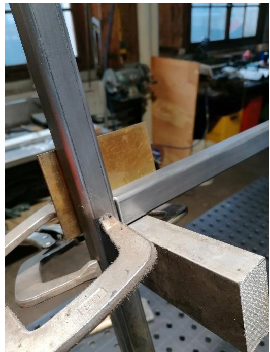
Abbildung 16 Auf diesem Bild sieht man, wie ich die Querstäbe zum Schweissen positioniert habe
