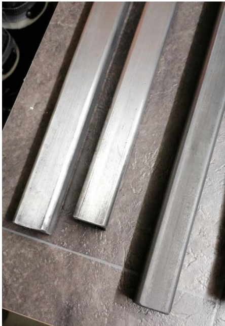
Abbildung 15 Man erkennt gut den Unterschied zwischen den silbernen schon verputzten und den anderen Vierkantröhren
