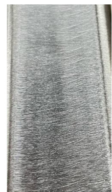
Abbildung 16 Test Tischbein mit Winkelschleifer
