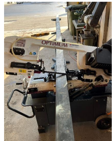
Abbildung 17 Absägen der Tischbeine auf 80 cm
