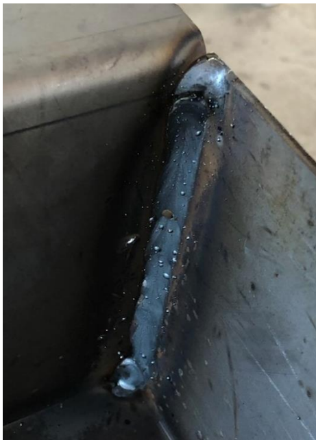
Abbildung 29 Schweissnaht der Innenwanne
