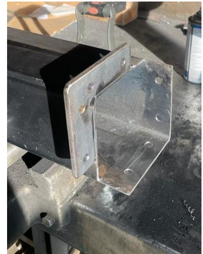
Abbildung 22 Winkel an Tischbein angeschweisst
