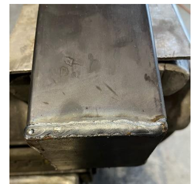
Abbildung 20 Schweissnaht Tischbeine Fus
