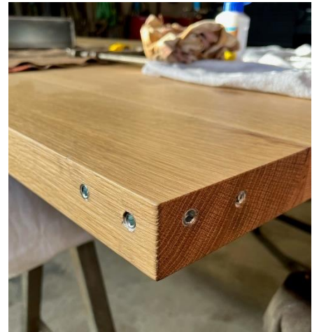
Abbildung 25 Eingeschraubte Hülsen für Tischbeine
