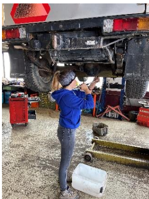
Abbildung 31 Hier habe ich die Niveauschraube gelöst
