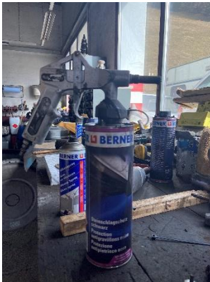
Abbildung 34 Mit dieser Pistole trägt man den Unterbodenschutz auf
