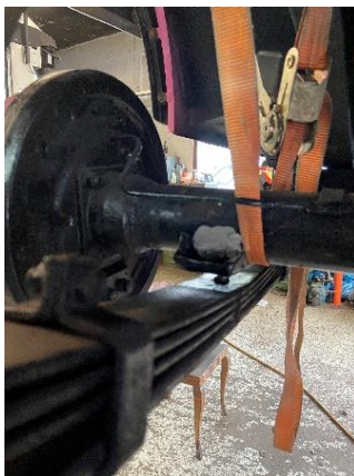
Abbildung 97 Hier mussten wir das Loch von der Hinterachse mit einem Kleber zu machen
