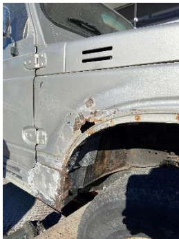
Abbildung 40 Rostloch vorne rechts am Kotflügel
