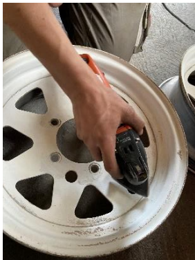
Abbildung 47 Hier schleife ich die Felge mit einer dreieckigen Schleifmaschine
