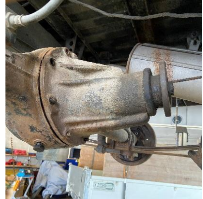
Abbildung 12 Die Hinterachse hat zu viel Spielraum zum Getriebe
