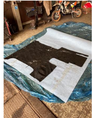
Abbildung 92 Wir haben mit der alten Vorlage den neuen Teppich zugeschnitten
