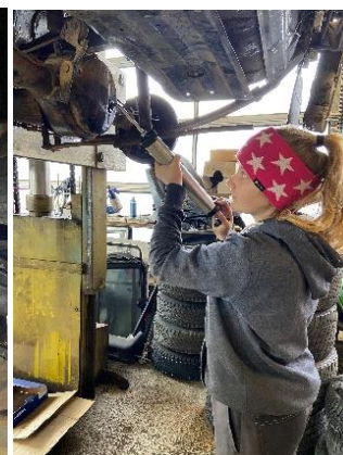
Abbildung 29 Mit einer Spritze habe ich das Getriebeöl wieder reingepumpt
