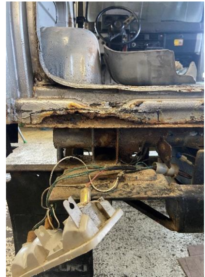
Abbildung 18 Riesiges Rostloch, das unter der Stossstange war
