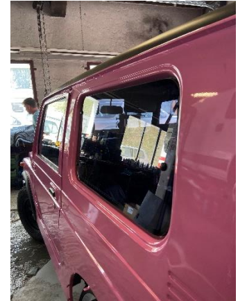
Abbildung 99 Getönte Fenster montiert
