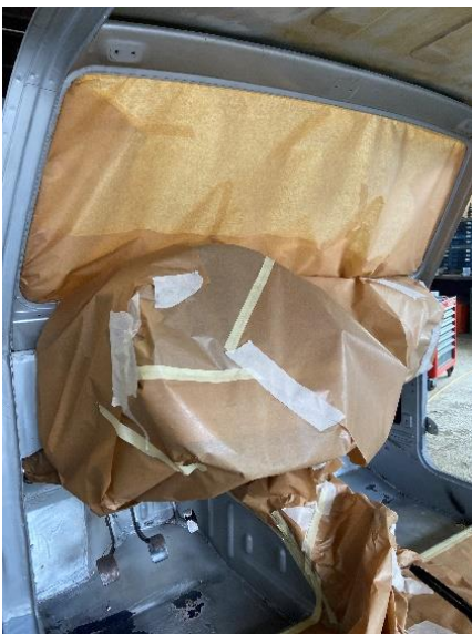
Abbildung 57 Hier haben wir das Armaturenbrett gut abgedeckt
