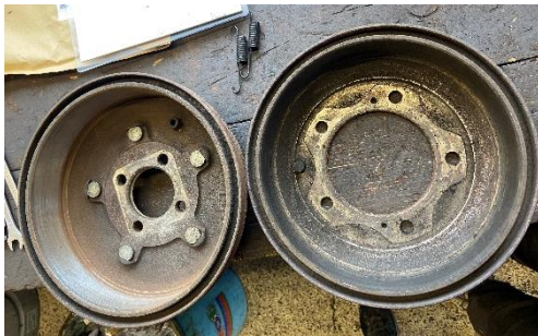
Abbildung 27 Die Bremstrommeln haben wir mit Schleifpapier aufgeraut
