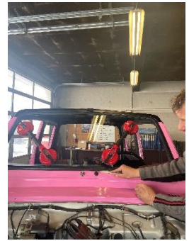
Abbildung 86 Hier haben wir die Frontscheibe wieder montiert
