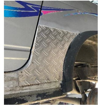
Abbildung 37 Das ist das Riffelblech, das er überall aufgetragen hat
