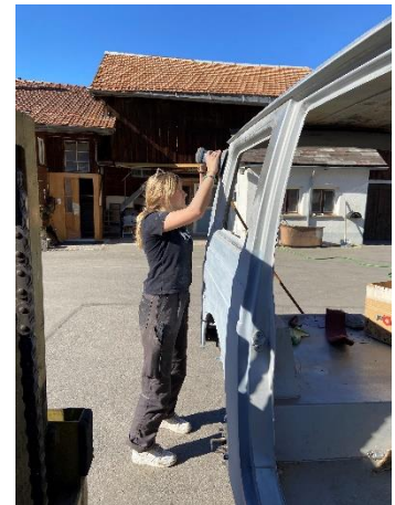
Abbildung 55 Ich schleife mit der Schleifmaschine die Aussenseite des Jeeplis
