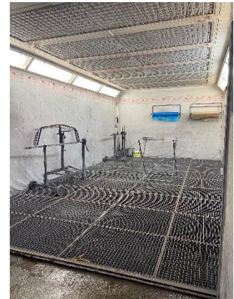
Abbildung 71 Dies ist die Spritzkabine, wo wir die Teile gespritzt haben
