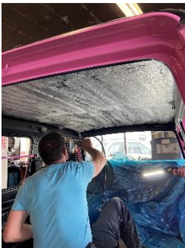
Abbildung 96 Hier trägt Papa den Spezialkleber auf
