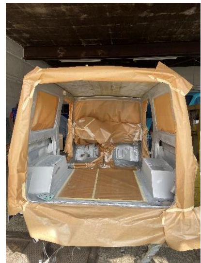
Abbildung 56 Hier ist der Innenraum sauber abgeklebt
