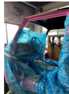
Abbildung 83 Die Ganghebel waren aufs Spritzen vorbereitet
