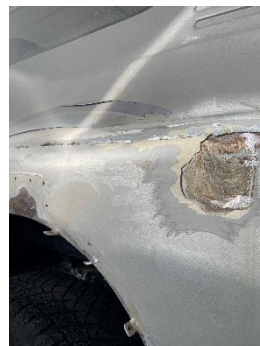
Abbildung 38 Abgeblättrtes Material, vor der Behandlung
