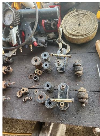
Abbildung 43 Alle abmontierten, kaputten Silentblöcke
