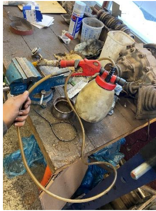
Abbildung 32 Mit diesem Gerät haben wir die Bremsflüssigkeit durchgespült
