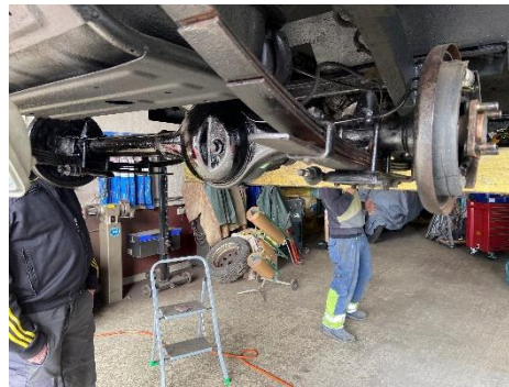
Abbildung 33 Hier sieht man den geschwärzten Unterbodenschutz
