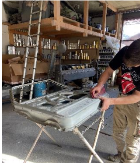
Abbildung 46 Schleifarbeit an der Türe
