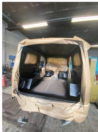
Abbildung 60 Das ist das Endergebnis des gespritzten Innenraums
