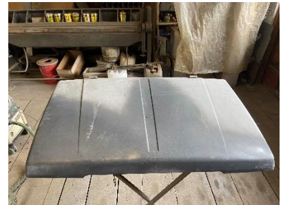
Abbildung 48 Die Motorhaube wurde gefüllter und bereits geschliffen
