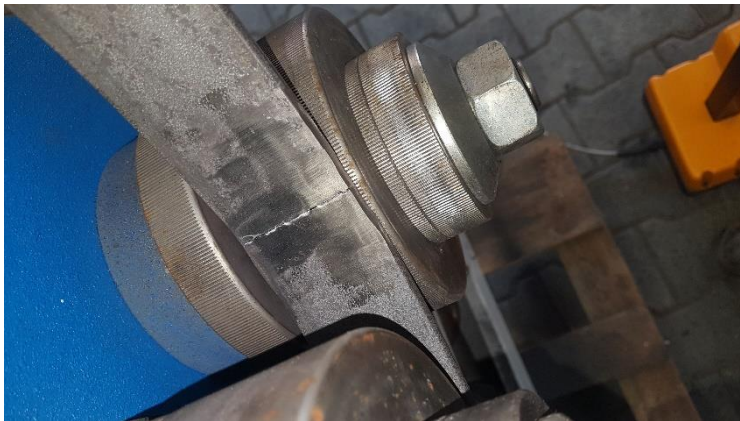
Abbildung 17 So sah es aus, als es die Naht sprengte.
