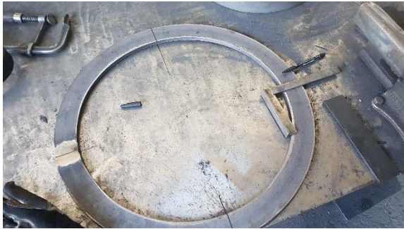
Abbildung 17 Hier zeichnete ich die Viertel für die Verstrebungen an.
