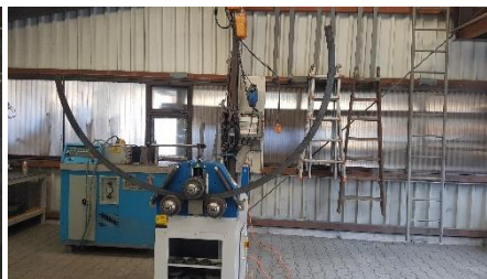
Abbildung 16 Hier biege ich den Standfuss mit der Rohrbiegemaschine.
