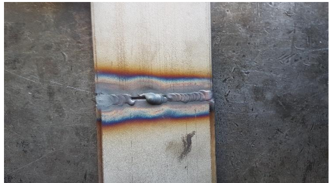
Abbildung 20 Das ist eine meiner ersten TIG Schweissnähte.
