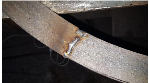
Abbildung 18 Das ist eine meiner ersten Schweissnähte, die ziemlich hässlich ist.
