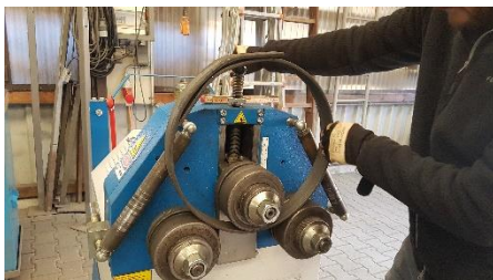
Abbildung 15 Hier biegen wir den Schalenhalter.
