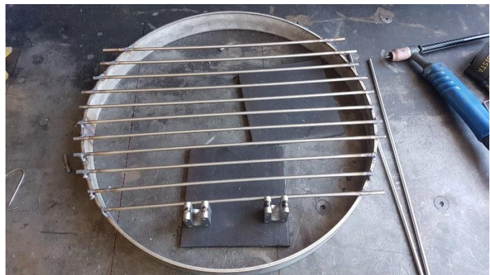
Abbildung 21 Das ist der Grillrost in der Bauphase.
